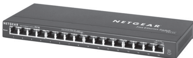
Figure 3.11 : Ce switch permet de relier jusqu'à 16 ordinateurs.
