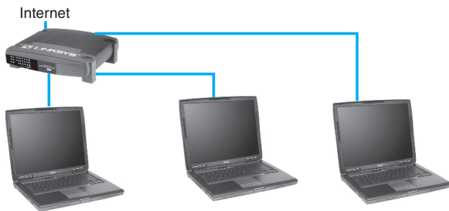
Figure 3.7: Liaison de trois ordinateurs en Ethernet et partage Internet.
