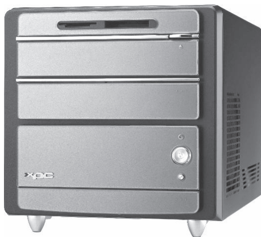
Figure I.20 : Les boîtiers Shuttle occupent une place réduite mais ont souvent tendance à chauffer excessivement.
