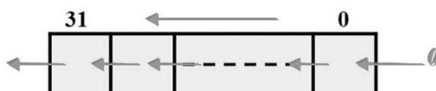
Figure 7.10 Décalage logique à gauche.
