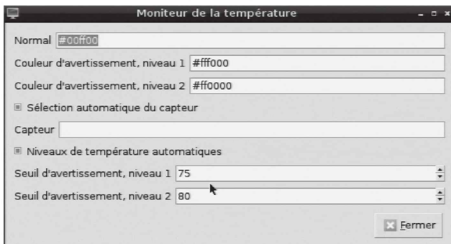
Figure 3.17 – La surveillance de température dispose de deux seuils d'alerte réglables.
