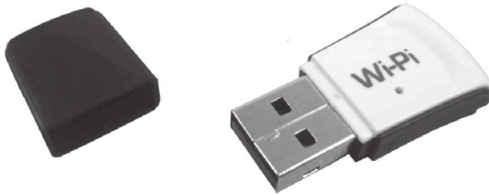
Figure 3.2 – La clé USB WiFi, appelée Wi-Pi, est particulièrement simple à configurer.
