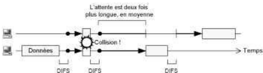
Figure 3.4 — La gestion des collisions avec le CSMA/CD.
