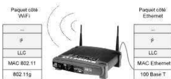
Figure 4.5 — Exemple de pont 802.11g/Ethernet 2 .
