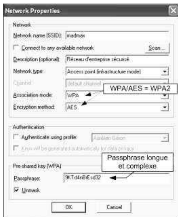
Figure 9.1 — Configuration WPA2 en mode PSK avec le logiciel de connexion Odyssey.
