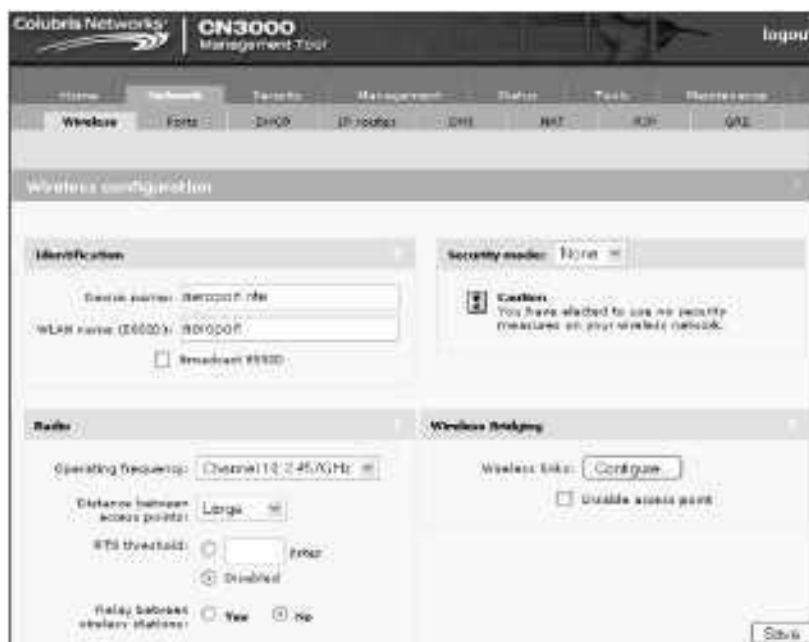
Figure 4.14 — Exemple d'interface web d'administration d'un point d'accès.
