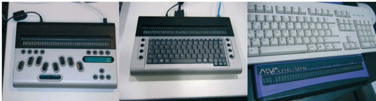
Figure 2-3 Différents modèles de plages Braille : les picots se lèvent et s'abaissent pour composer des lignes de texte en Braille au fur et à mesure de la lecture.
