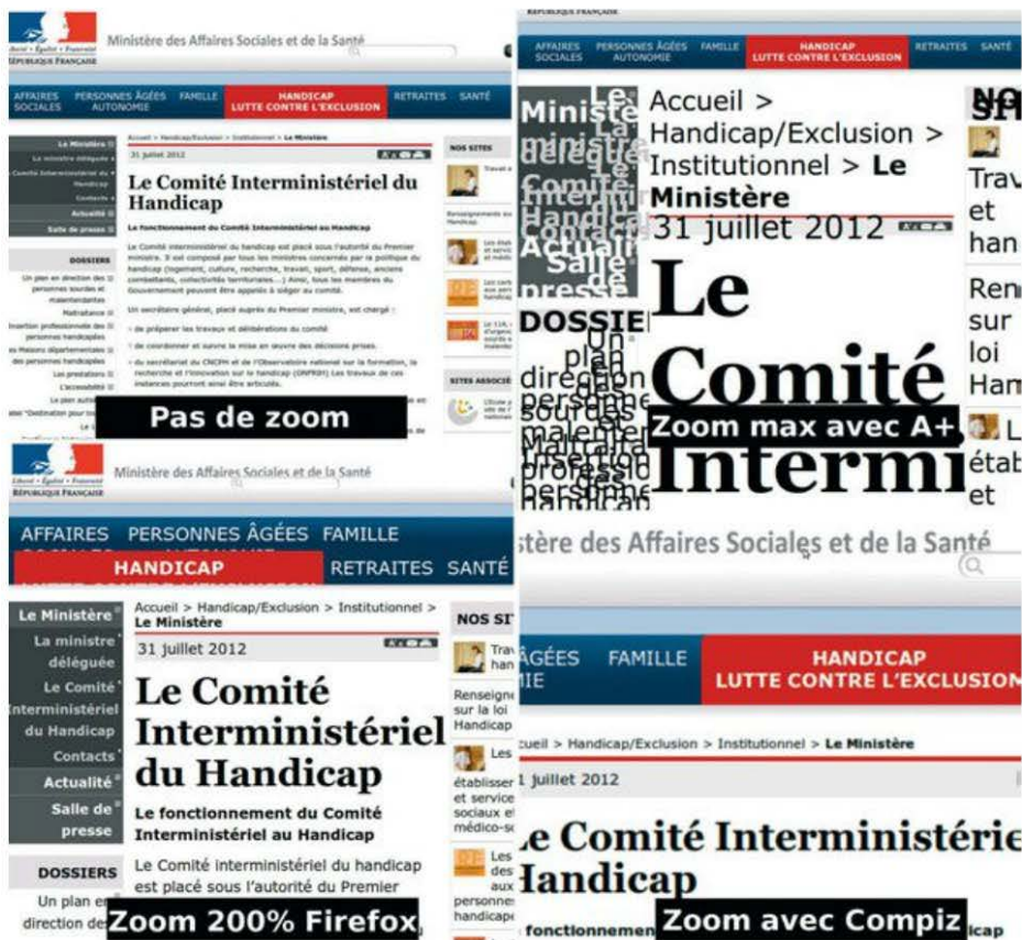
Figure 2-4 Comparaison entre différents modes d'agrandissement sur le site du Comité interministériel du handicap : en haut à gauche, la page sans agrandissement ; en haut à droite, un agrandissement maximal avec le bouton A+ disponible sur le site (le résultat est illisible et ne permet d'agrandir que le contenu, pas les menus) ; en bas à gauche, un agrandissement à 200 % avec Firefox (permet de tout agrandir, mais une mauvaise conception du site fait se chevaucher les blocs) ; enfin, un agrandissement avec la loupe de Compiz sur Ubuntu, seul moyen de vraiment agrandir toute la page. ( http://ur1.ca/abz20a )
